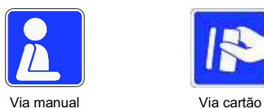
Figura 15 – Eventuais futuros sinéis a utilizar em PMV do Tipo a4, nas vias de acesso a portagens
